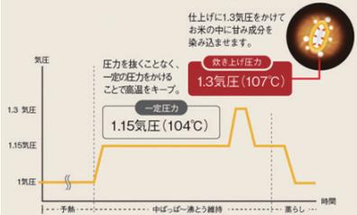
蒸らす前に1.3気圧の圧力をかけて水中に
